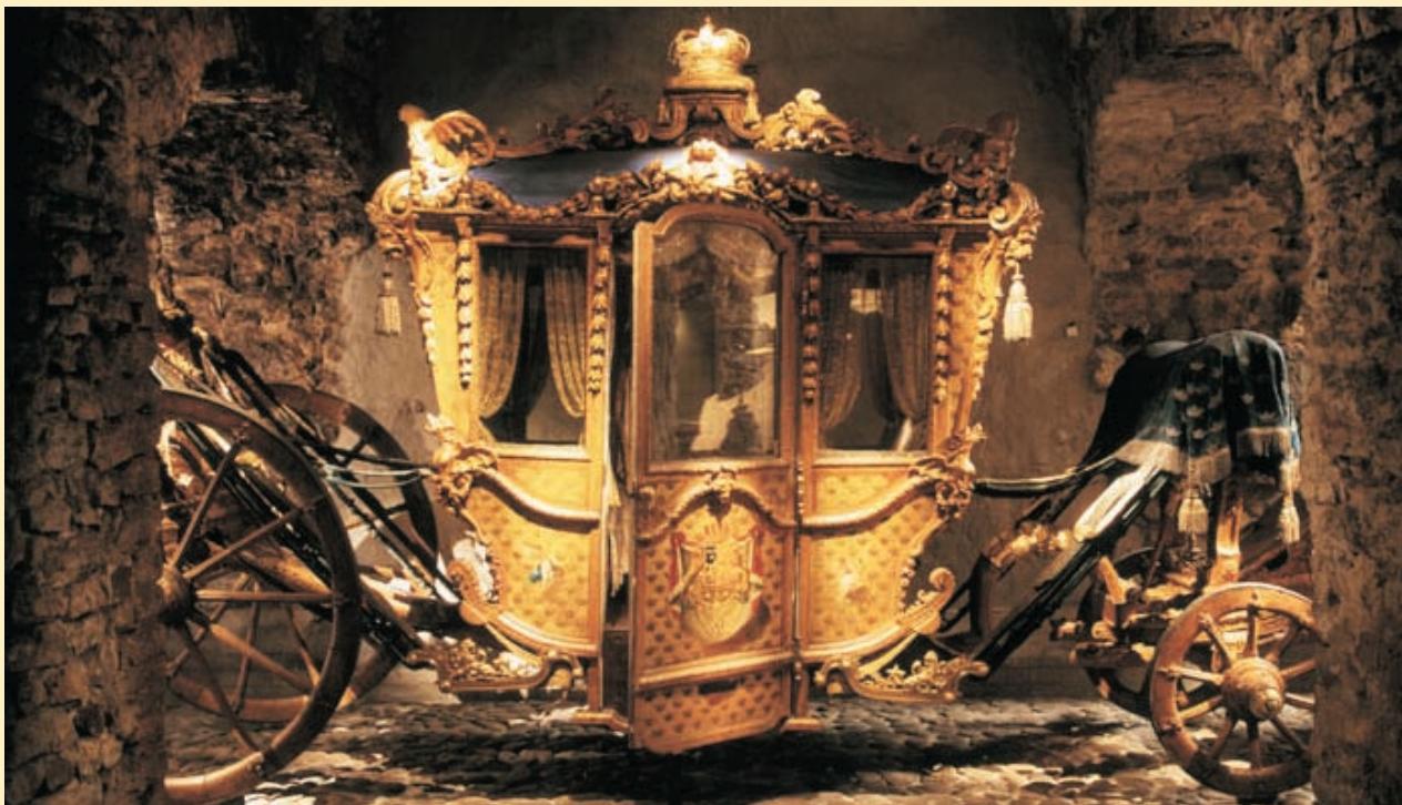
I Paris 1696-99 tillverkad kröningsvagn. Längd: 664 cm. Bredd: 196 cm. Höjd: 326 cm. Vikt: 1500 kg. Materialet är trä (stommen ek), stål, brons och fönstren är slipat kristallfönsterglas. Alla trä- och metalldelar är förgyllda. Fjädring: à la Daleme, dvs. fyra bladfjädrar under korgen. Korgen hänger i fyra hängremmar. Läderrämmarna är överklädda med blå sammet. Framvagnen har vändkrans, förvåg och svänglar.
